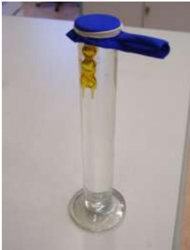
Determinando una variazione di pressione del liquido circostante al diavoletto si determina una variazione del volume dell'aria all'interno dello strumento che scende o sale rispettivamente a seconda se si aumenta o si diminuisce la pressione dall'esterno.
