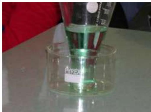
fuori della beuta e che viene esercitata sulla superficie dell'acqua nel cristallizzatore. Questo equilibrio di pressione impedisce la possibilità da parte delle particelle di acqua di penetrare all'interno della beuta.
